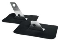
Zur Befestigung von Schneefangrohren, mit werkseitiger RESITRIX® Anschluss-Manschette 350/250 mm inkl. Vierkantschraube M10 und Muller.
